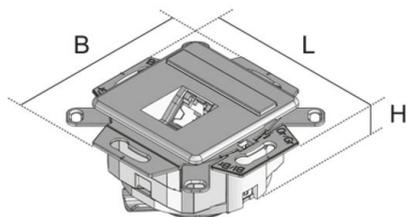
Schraubbare, 8-polige Cat.6A-iso-Datendose geschirmt, mit Zentralstück, Stecköffnung für 8-polige Stecker (RJ45) schräg nach unten geneigt, in abbrechbarer Tragringausführung für Gerätebechereinbau.
