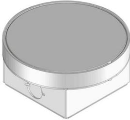
Runde Reinigungssteckdose aus Aluminium mit Stoßkante. Inkl. weißer 1-facher Schutzkontaktsteckdose. Als nivellierbare Einheit mit Tubusdeckel, Aufnahmegehäuse aus Stahlblech. Zum direkten Einbau in Estrichböden. Für Räume mit geringem Fußbodenaufbau und nass gepflegten Bodenbelägen geeignet. Ausgelegt für Büroverkehrslasten.
