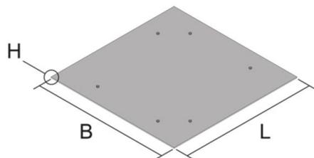
Stahlplatte als optionales Zubehör zum temporären Abdecken einer Montageöffnung im Doppel- oder Estrichboden, die durch das Entfernen eines Schalungskörpers oder einer Kunststoffschalung entsteht. (Durchmesser 307mm und 261x261mm). Mit Einpressgewindebolzen als Verrutschsicherung.
