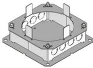
Hohlraumbodendose bestehend aus einem sendzimirverzinktem Stahlblechkasten mit allseitig aufbiegbaren Seitenwänden inkl. Erdungsklemme zur trittschallfreien und höhenunabhängigen Montage. Verwendbar als Zug- und Einbaudose, mit einer Einbauöffnung zur Aufnahme eines Schalungskörpers, der bei der Endmontage durch einen runden Einzelauslass BODO ersetzt wird.
