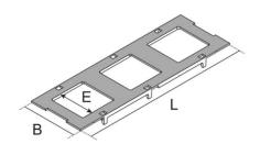
Abdeckplatte schwarz aus Kunststoff, einteilig, rastbar, zum Einbau von drei Installationsgeräten mit Hängebügel, als systemgebundenes Zubehör zum Gerätebecher.
