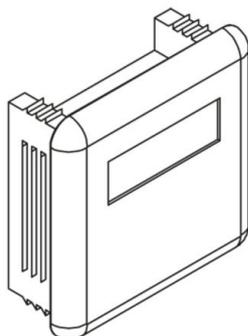
Schutzkappe zum Einsetzen für Profilschienen mit Innenmaß 36x31,5 mm. Zur Abdeckung und Schutz der Profilenden.
