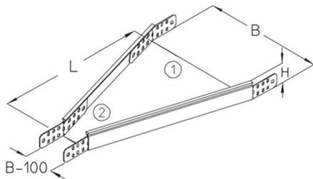
Bei Bestellungen bitte die Bauform (links, mittig, rechts) sowie die Seitenbreite mit angeben. Die erste Abbildung mit Bemaßung zeigt die Bauform mittig. Dieser Artikel ist in Edelstahl mit der Werkstoff-Nr. 1.4571/1.4404 (V4A) erhältlich.
