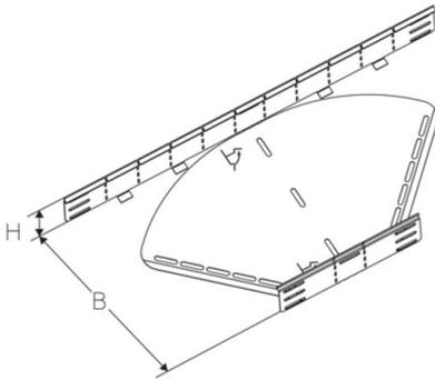
Variabler Rinnenbogen 0 – 90 Grad, zur horizontalen Richtungsänderung mit integrierten Verbindern. Mit Langlöchern zur Befestigung von Trennstegen oder Konsolen. Um mehr Steifigkeit bei größeren Winkeln zu erhalten, kann die Außenseite, ab einer Breite von 200 mm, mit dem Boden verbunden werden. Für den Kabelschutz sind die Kanten am Kopf des variablen Rinnenbogens umgefaltet.
