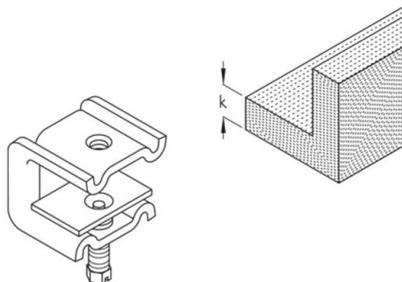
Montageklemme aus Stahl mit genietetem Druckplatte zur Klemmbefestigung an Stahlträgern.
