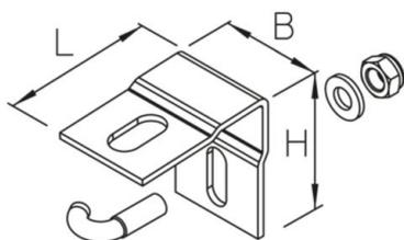
Sicherungswinkel zur zusätzlichen Sicherung der Gitterbahndeckel insbesondere im Außenbereich
