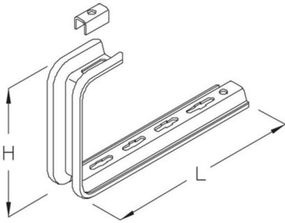
Die Artikel sind im Brandschutz verwendbar. Dieser Artikel ist nur in Verbindung mit der Kabelrinne für Normtragekonstruktion zu verwenden. Technische Parameter siehe Allgemeines bauaufsichtliches Prüfzeugnis (AbP).
