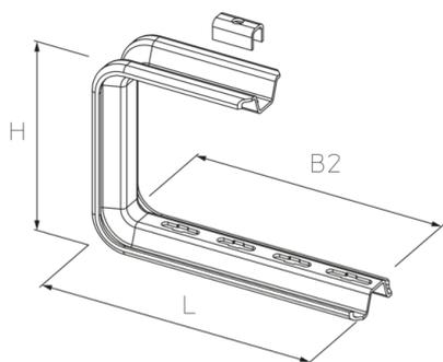
$F_D/P$ : Faktor zur Berechnung der Dübellast  $F_D$  mit tatsächlicher Konsollast  $P$  bzw. Summe tatsächlicher Konsollasten. Lastangaben gelten nur für Befestigung als Deckenkonsolle. Die Montage des Zwischenstücks KSL-SP bei der Deckenmontage ist erforderlich, um Verformungen des Profils durch Kraftschluss der Befestigungsschraube zu vermeiden.
