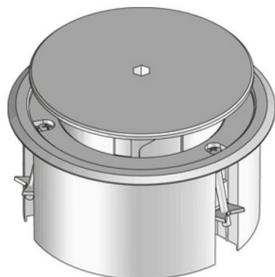
Runder Einzelauslass aus Kunststoff mit Bodenbelagsschutzrahmen inklusive drehbarem Deckel mit Kabelauslass und Krallenset. Zum Einbau in Estrich und Doppel- oder Hohlraumbodenöffnungen. Für Räume mit trocken gepflegten Bodenbelägen geeignet. Ausgelegt für Büroverkehrslasten.
