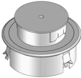
Runder Einzelauslass mit Bodenbelagsschutzrahmen. Inklusive schwenkbarem Tubus, drehbarem Kabelauslass, Deckel, Krallenset und Gummidichtung. Zum Einbau in Estrich und Doppel- oder Hohlraumbodenöffnungen. Für Räume mit trocken und nass gepflegten Bodenbelägen geeignet. Ausgelegt für hohe Verkehrslasten.
