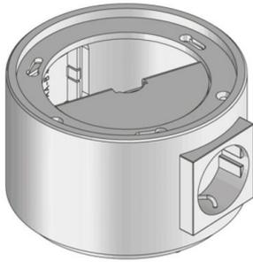
Runder vorkonfektionierter Tubusauslass, Einsatz nur in Verbindung mit Leitungsauslass, blind. Bestückt mit einer schwarzen Schutzkontaktsteckdose und einem schwarzen Snap-In. Kann durch ein weiteres Installationsgerät 45x45 mm komplettiert werden. Tubus mittels Bajonettverschluss zu schließen. Zum Einbau in Estrich und Doppel- oder Hohlraumbodenöffnungen. Für Räume mit trocken und nass gepflegten Bodenbelägen geeignet. Ausgelegt für hohe Verkehrslasten.
