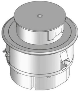
Runder Einzelauslass mit Bodenbelagsschutzrahmen. Inklusive schwenkbarem Tubus als Kabelauslass, Deckel, Gerätebecher mit Zugentlastung, Krallenset und Gummidichtung. Zum Einbau in Estrich und Doppel- oder Hohlraumbodenöffnungen. Ausgestattet mit einer Schutzkontaktsteckdose 45x45mm und einer RJ45 Datendose 22,5x45mm (Legrand Typ Cat. 6A STP RJ45, 76573). Für Räume mit trocken und nass gepflegten Bodenbelägen geeignet. Ausgelegt für hohe Verkehrslasten.
