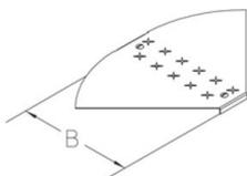
Der Deckel besteht aus einem 2 mm bandverzinktem Stahlblech mit 1 mm rutschhemmender Prägung sowie einer Rutschhemmung R12 nach DIN 51130. Unter Einhaltung der Montagevorgaben und einer maximalen Fachgröße von 200 mm garantiert der Deckel eine geprüfte Belastbarkeit von mindestens 500 kg nach EN 50085-2-2.
