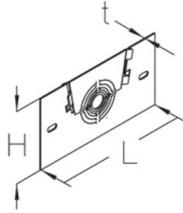
Mögliche Durchmesser von Verschraubungen von Adaptern sind M20/M25/M32/M40/M50/PG13,5/PG21/PG29.
