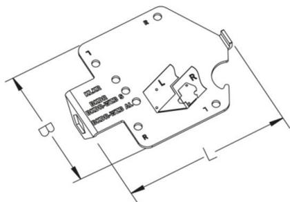
Das Bodenkanal-Multitool kommt primär als Schablone zum Einsatz. Es kann zum Anzeichnen der Positionen von Verbindern und Drehriegeln verwendet werden. Außerdem eignet sich das Tool zum Ausschlagen der Butzen und zum Festziehen der Drehriegel.
