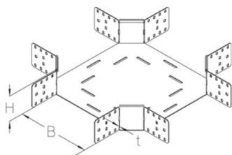
Ab einer Breite ? 300 mm muss ein Trennsteg verbaut werden. Ab einer Breite ? 500 mm müssen zwei Trennstege verbaut werden.
