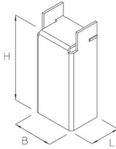
Ab einer Länge von 392 mm BKHR empfiehlt sich die Verwendung von BKHRU. Die Unterstützung muss nicht mit dem Boden verschraubt werden. Das setzen von Dübeln entfällt.
