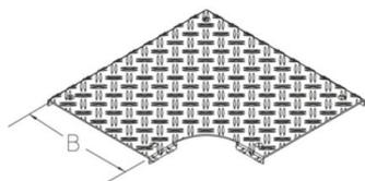
Der Deckel besteht aus einem 2,5 mm starken Aluminiumblech mit 1,5 mm rutschhemmender Prägung sowie einer Rutschhemmung R10 nach DIN 51130. Unter Einhaltung der Montagevorgaben und einer maximalen Fachgröße von 200 mm garantiert der Deckel eine geprüfte Belastbarkeit von mindestens 300 kg nach EN 50085-2-2.
