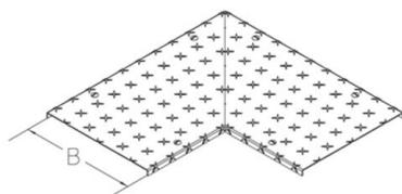
Der Deckel besteht aus einem 2 mm bandverzinktem Stahlblech mit 1 mm rutschhemmender Prägung sowie einer Rutschhemmung R12 nach DIN 51130. Unter Einhaltung der Montagevorgaben und einer maximalen Fachgröße von 200 mm garantiert der Deckel eine geprüfte Belastbarkeit von mindestens 500 kg nach EN 50085-2-2.
