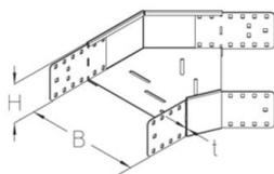
Ab einer Breite ? 300 mm muss ein Trennsteg verbaut werden. Ab einer Breite ? 500 mm müssen zwei Trennstege verbaut werden.
