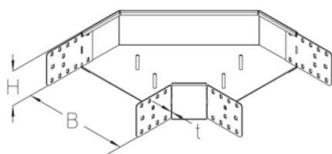
Ab einer Breite ? 300 mm muss ein Trennsteg verbaut werden. Ab einer Breite ? 500 mm müssen zwei Trennstege verbaut werden.
