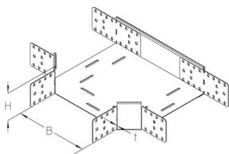
Ab einer Breite  $\geq$  300 mm muss ein Trennsteg verbaut werden. Ab einer Breite  $\geq$  500 mm müssen zwei Trennstege verbaut werden.
