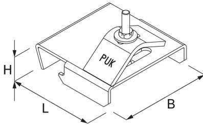
Weitspannkabelleiter-Verbinder T-Stoß oben WPVTO dient zur Herstellung einer Abzweigung von höhenversetzten Weitspannkabelleitern WPL. Der Verbinder wird im 45° Winkel auf das Holmprofil der Weitspannkabelleiter WPL gesteckt und heruntergeklappt. Mit den beigelieferten Klemmbefestigungen SKLL wird die Weitspannkabelleiter WPL befestigt. Verschiedene Materialien und Oberflächen sorgen dafür, dass die Korrosionsanforderungen unterschiedlichster Anwendungsgebiete erfüllt werden.
