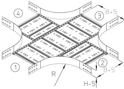
Die Weitspannkabelrinnen-Kreuzung WPRK 150 mit integrierten Verbindern dient als Formteil für sich horizontal kreuzende Weitspannkabelrinnen. Sie eignet sich für Rinnen mit einer Holmhöhe von 150 mm und weist Breiten von 200 bis 600 mm auf. Die Anschlussrinnen lassen sich mit einem Bodenverbinder VB einschieben. Verschiedene Materialien und Oberflächen sorgen dafür, dass die Korrosionsschutzerfordernisse unterschiedlichster Anwendungsgebiete erfüllt werden.
