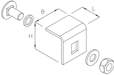
Der Sturmsicherungswinkel WLD-SW dient der zusätzlichen Sicherung der Weitspann-Deckel bei Verwendung im Außenbereich. Es sind mindestens 6 Sicherungselemente pro 3 Meter Kabelbahn-Deckel gemäß der Montageanleitung zu verwenden. Bei windexponierten Bereichen muss die Anzahl der Deckelklammern auf mindestens 10 Stück erhöht werden. Der Sturmsicherungswinkel wird von außen auf den Weitspann-Deckel aufgesetzt und verschraubt. Er besteht aus tauchfeuerverzinktem Stahl.
