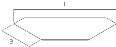
Der Weitspann-Bogen-Deckel WLBD eignet sich für die Weitspann-Bögen WLB 200 und WLRB 200 und schützt sie vor Schmutz, Feuchtigkeit und UV-Strahlung. Er wird auf dem Bogen aufgesetzt und mit den Sicherungswinkeln WLD-SW gesichert. Verschiedene Materialien und Oberflächen sorgen dafür, dass die Korrosionsschutzanforderungen unterschiedlichster Anwendungsgebiete erfüllt werden.
