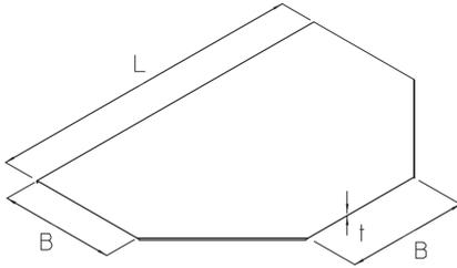
Der Weitspann-Abzweig-Deckel WLAD eignet sich für die Weitspann-Abzweige WLA 200 und WLRA 200 und schützt sie vor Schmutz, Feuchtigkeit und UV-Strahlung. Er wird auf dem Abzweig aufgesetzt und mit den Sicherungswinkeln WLD-SW gesichert. Verschiedene Materialien und Oberflächen sorgen dafür, dass die Korrosionsschutzanforderungen unterschiedlichster Anwendungsgebiete erfüllt werden.
