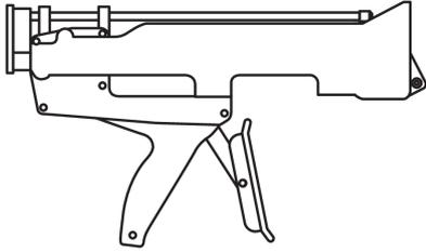
Das Auspressgerät VA-AP für 2-Kammer-Kartuschen dient dem schnellen und ermüdungsfreien Ausdrücken des Verbundankermörtels VAB-HB M. Die Herstellerangaben sind zwingend einzuhalten.
