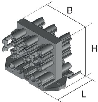
Bei den Bauelementen UVWI handelt es sich um Verteilerblöcke des Herstellers Wieland. Die Verteiler besitzen eine Verriegelung, eine Befestigungsmöglichkeit sowie einen 5-poligen Eingang und sechs 3-polige Ausgänge mit Durchgangsverdrahtung. Die Blöcke sind aus Polyamid gefertigt.
