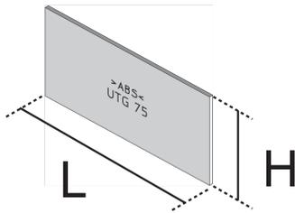
Bei den Bauelementen UTG 75 handelt es sich um Gerätetrennwände aus dem Portfolio der Unterflursysteme. Sie werden an der seitlichen Perforation abgebrochen und von unten in die Gerätebecher eingesetzt. Dort sorgen sie für eine sichere Trennung von unterschiedlichen Stromkreisen und Bestückungen - eine Maßnahme, um Störungen und Fehlfunktionen zu vermeiden. Die Trennwände sind aus hochwertigem Acrylnitril-Butadien-Styrol-Copolymerisat (ABS) in der Farbe Graphitschwarz (RAL 9011) gefertigt.
