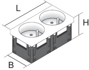
Bei den Bauelementen UST45FR 2 handelt es sich um einteilige, 2-fache Einbausteckdosen mit Erdungsstift in einer Ausführung von 45x45 mm. Sie lassen sich mithilfe von Steckklemmen in die passenden UAM-Abdeckplatten einsetzen. Die Steckdosen werden aus hochwertigem Polycarbonat gefertigt und sind in verschiedenen Farben erhältlich. Die 2-poligen Schutzsteckdosen besitzen einen erhöhten Berührungsschutz und sind für eine Nennspannung/- Stromleistung von AC 250 V, 10/16 A geeignet.
