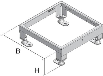
Bei den Bauelementen UNE handelt es sich um viereckige, blinde Nivelliereinheiten aus einem Stahlblechrahmen, innenliegender Nivellierung mit Nivellierfüßen und Erdungsklemmen. Die Einheiten werden, auf Edelstahlkassetten montiert, für Bodendosen, Montagedeckeln und Doppel- oder Hohlraumbodenöffnungen in Räume mit hohen Verkehrslasten verwendet. Sie sind aus sendzimir-feuerverzinktem Stahl (DIN EN 10346) gefertigt und besitzen ein Einbaumaß von 261 x 261 mm.
