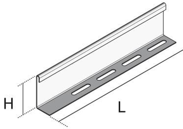
Bei der Produktlösung UKTR handelt es sich um Trennstege für estrichüberdeckte Kanalsysteme. Je nach Kanalbreite müssen ein oder zwei dieser Bauelemente mit einem Dübel auf der Rohbetondecke befestigt werden - immer symmetrisch und im Versatz zum Kanal. Die Trennstege sind aus sendzimir-feuerverzinktem Stahlblech nach DIN EN 10346 gefertigt und in einer Länge von 3000 mm und in verschiedenen Höhenmaßen erhältlich.
