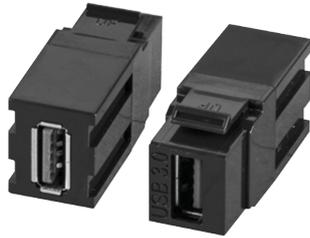
Bei den Bauelementen UKM-USB3A handelt es sich um Keystone Einbauadapter zur Bestückung von Unterflursystemen. Die Adapter besitzen zwei USB 3.0-Verbindungsbuchsen Typ A und lassen sich in Datenaufnahmeeinheiten mit einer 19,5x14,7 mm großen Einbauöffnung einrasten. Ihre schwarzen Gehäuse sind aus hochwertigem Polycarbonat gefertigt.
