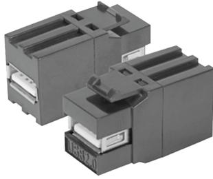
Bei den Bauelementen UKM-USB2A handelt es sich um Keystone Einbauadapter zur Bestückung von Unterflursystemen. Die Adapter besitzen zwei USB 2.0-Verbindungsbuchsen Typ A und lassen sich in Datenaufnahmeeinheiten mit einer 19,5x14,7 mm großen Einbauöffnung einrasten. Ihre schwarzen Gehäuse sind aus hochwertigem Polycarbonat gefertigt.
