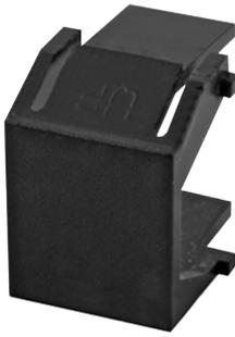
Bei den Bauelementen UKM-B handelt es sich um Keystone Blindeinsätze zur Bestückung der Unterfloreinheiten. Sie dienen dort als Abdeckung ungenutzter Ports. Die Einsätze lassen sich in Datenaufnahmeeinheiten mit einer 19,5x14,7 mm großen Einbauöffnung einrasten. Ihr schwarzes Gehäuse ist aus hochwertigem Polycarbonat gefertigt.
