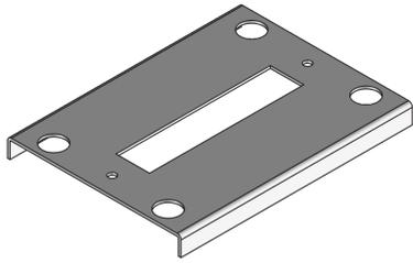
Beim Bauteil UKENPS handelt es sich um eine Schwerlastplatte aus dem Produktsortiment der Unterflursysteme. Sie wird zwischen der Nivellierplatte UKENP und dem Kompakteinzelauslass platziert. Dank der Platte kann die Konstruktion eine Last von bis zu 20 kN abtragen. Die Schwerlastplatte ist aus sendzimir-feuerverzinktem Stahlblech nach DIN EN 10346 gefertigt.
