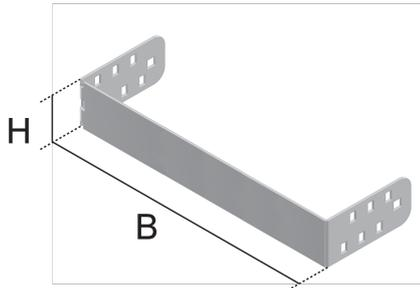
Bei der Produktlösung UKEB handelt es sich um Endbleche, die zum Verschließen estrichüberdeckter Kabelkanäle verwendet werden. Die Bauelemente der Unterflursysteme sind aus sendzimir-feuerverzinktem Stahlblech nach DIN EN 10346 angefertigt. Sie sind in einer Breite von 300 bis 500 mm erhältlich. Bei einer Höhe von 20 bis 45 mm werden sie inklusive eines Klemmbefestigungssets KLR und ab einer Höhe von 70 mm inklusive zweier Sets geliefert.
