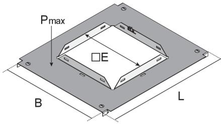
Bei der Produktlösung UKDA 260V handelt es sich um Kabelkanal Montagedeckel mit eckigen Einbauöffnungen für offene, estrichüberdeckte Kanalsysteme. Sie dienen als Zug- und Einbaudosen, die in ihre Einbauöffnung einen Schalungskörper aufnehmen. Die Montage deckel sind aus sendzimir-feuerverzinktem Stahlblech nach DIN EN 10346 gefertigt. Sie sind, inklusive Erdungsklemme UBDHB-Z, in einer Breite von 300 bis 500 mm und einer maximalen Belastungshöhe von 0,75 kN erhältlich.
