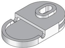
Bei Verwendung der UGM SLF erhöht sich der Nivellierbereich um 3 mm
