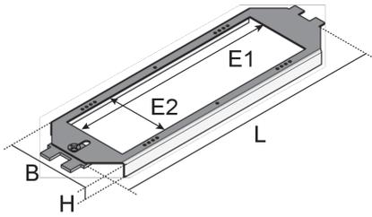
Bei den Bauelementen UGET 3-1 handelt es sich um Geräteträger aus dem Sortiment der Unterflursysteme. Sie werden von oben in die passenden Gerätebecher gesetzt und dort verschraubt. Anschließend können die Einbauträger, entlang der Befestigungsspur, mit bis zu drei ACO-AMP Platinen der Größe 60x70mm bestückt werden. Im Falle von leeren Einbauöffnungen dienen die Abdeckungen UAA B 65 als zuverlässiger Schutz.
