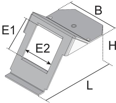
Bei den Bauelementen UGET 1 UST45 handelt es sich um Gerätebechereinbauträger aus dem Portfolio der Unterflursysteme. Die Einbauträger werden in die Gerätebecher UG geschraubt und dienen dort zur Aufnahme eines Installationsgerätes mit den Abmaßen 45x45 mm der Hersteller PEHA, Legrand oder Simon. Die Geräteträger sind aus sendzimir-feuerverzinktem Stahlblech, nach DIN EN 10346, in der Farbe Schwarz (ähnlich RAL 9011) gefertigt und mit den Einbaumaßen E1 von 40,5 und E2 von 40,5 mm erhältlich.
