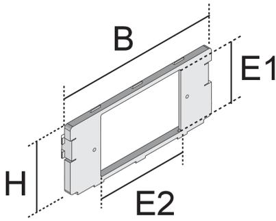
Bei den Bauelementen UGEE 1 DEP S handelt es sich um Geräteblenden aus dem Sortiment der Geräteeinsätze für Datentechnik. Sie werden bei der Montage in den Geräteeinsatz gegenüber der Starkstromtechnik frontal und bündig zum Boden des Einsatzes eingerastet und können dort mit einer Einbauplatine UDEP bestückt werden. Die Blenden sind aus hochwertigem Polyamid in der Farbe Schwarz (ähnlich RAL 9011) gefertigt.
