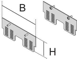
Bei den Bauelementen UGEAV2 handelt es sich um Rastleitersets aus zwei einzelnen Rastleitern. Sie lassen sich an Rahmen der Nivelliereinheiten für eckige Edelstahlkassetten mit Kabelauslass schrauben. Die Kassetten können anschließend mit bis zu zwei Gerätebechern für Installationsgeräte bestückt werden. Die Rastleitersets sind aus sendzimir-feuerverzinktem Stahl (DIN EN 10346) gefertigt.
