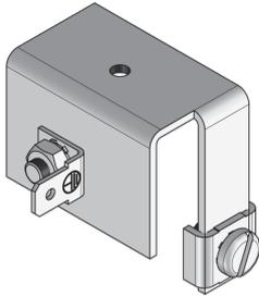
Bei den Bauelementen UGEAR ELS handelt es sich um Erdungswinkel, auch als Erdungslasche bezeichnet. Diese Zubehörteile für runde Edelstahl- Blinddeckel und runde Schwerlast-Blinddeckel unterstützen einen zuverlässigen Potentialausgleich bei der Verwendung von Einbaueinheiten aus Edelstahl. Die Winkel werden aus sendzimir-feuerverzinktem Stahlblech gefertigt.
