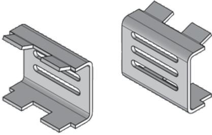
Bei den Bauelementen UGEA D handelt es sich um Datengeräteträgeradapter für Gerätebecher. Sie werden zur Aufnahme von diversen Komponenten von Montageträgersystemen verwendet und sind unter anderem kompatibel mit den Edelstahl-Klappdeckeleinheiten UEKD2 R und den Edelstahl-Rastleistersets UGEAV. Die Datengeräteträgeradapter werden aus sendzimir-feuerverzinktem Stahlblech gefertigt. Die Adapter werden pro Stück verkauft. Pro Gerätebecher werden 2 Adapter benötigt.
